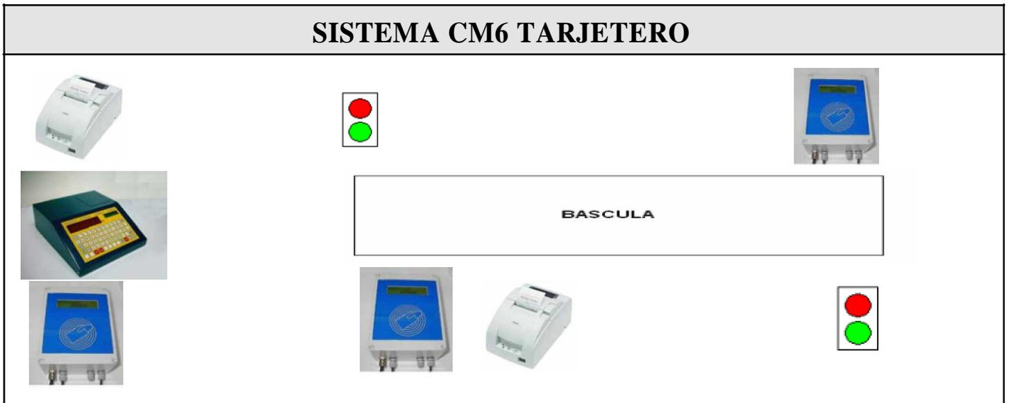
Con el equipo **CM6 TARJETERO** y los lectores **TRF1** podemos montar un sistema que permite hacer pesadas de forma automática.
